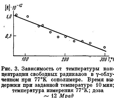
Рис. 3. Зависимость от температуры концентрации свободных радикалов в  $\gamma$ -облученном при 77° К сополимере. Время выдержки при заданной температуре 10 ми;
