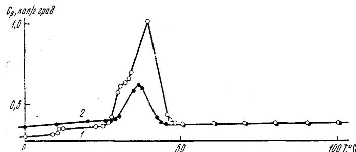
Рис. 3. Теплопроводность закристаллизованного образца полиуретана, содержащего 20 вес. ч. аэросила, предварительно нагретого до 200° (1) и до 100° (2)
