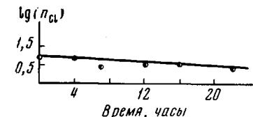
Рис. 3. Зависимость количества хлора в ПВХ-37 от времени нагревания ( $160^\circ$ )
