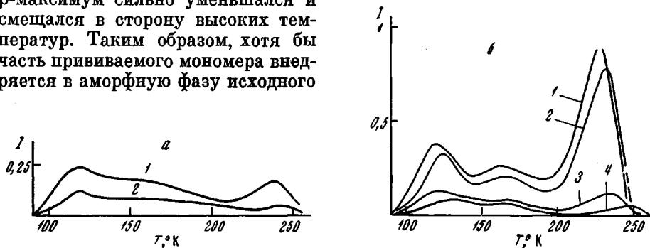
Рис. 4. Кривые высыпчивания привитых сополимеров на основе ПЭ и акрилонитрила, полученных методами пост-эффекта (а) и химической прививки (б):
