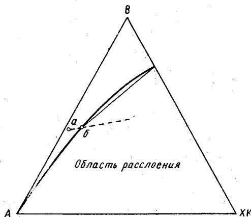
Рис. 1. Диаграмма фазового равновесия системы диацетат целлюлозы — ацетон — вода — хлористый кальций
