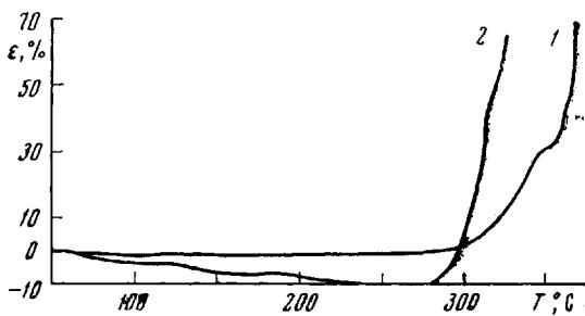
Рис. 6. Термомеханические кривые ПДЦТА (1) и ПТМТА (2)
