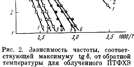
Рис. 2. Зависимость частоты, соответствующей максимуму  $\text{tg } \delta$ , от обратной температуры для облученного ПТФХЭ для  $\beta$ - (а) и  $\gamma$ - (б) процессов
