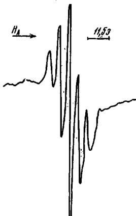
Рис. 4. Спектр ЭПР продукта нагревания N-НДФА при 120°
