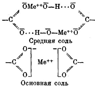
В качестве вулканизующих агентов использовали тонкодисперсные  $\text{ZnO}$ ,  $\text{MgO}$ . Последние предварительно активировали путем прокаливания при  $600^\circ$  в течение 4 час.
