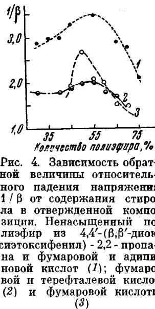
Рис. 4. Зависимость обратной величины относительного падения напряжения  $1/\beta$  от содержания стирола в отверженной композиции. Ненасыщенный полизифир из 4,4'-( $\beta,\beta'$ -диоксизотоксифенил)-2,2-пропана и фумаровой и адипиновой кислот (1); фумаровой и терефталевой кислот (2) и фумаровой кислоты (3)
