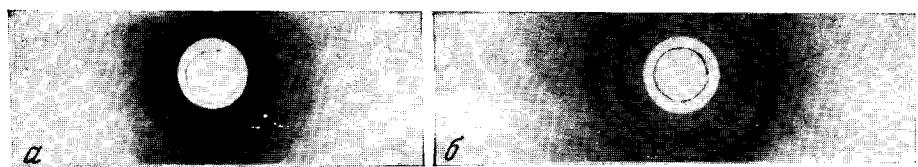
Рис. 2. Дебаеграммы образцов ПДХП-І (а), ПДХП-ІІ (б) после длительного отжига
