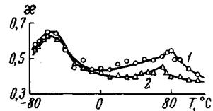
Рис. 3. Температурные зависимости коэффициента механических потерь  $\chi$  резины на основе БСК, наполненной сажами В<sub>граф</sub> (1), В<sub>терм</sub> (2) (50 вес. ч. сажи на 100 вес. ч. каучука) при  $v = 1$  колебаний/мин
