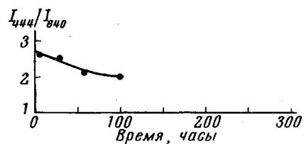
Рис. 6. Зависимость отношения  $I_{444}/I_{640}$  интенсивностей спектра диметилсилоксана (при 444 и 640 нм) от времени поликонденсации
