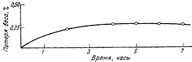
Рис. 11. Потеря веса во времени вальцованными образцами ПВХ при 160°
