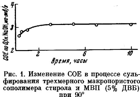
Рис. 1. Изменение COE в процессе сульфирования трехмерного макропористого сополимера стирола и МВП (5% ДВБ) при 90°
