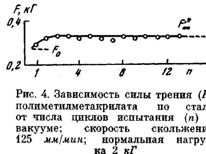
Рис. 4. Зависимость силы трения ( $F$ ) полиметилметакрилата по стали от числа циклов испытания ( $n$ ) в вакууме; скорость скольжения 125 мм/мин; нормальная нагрузка 2 кг
