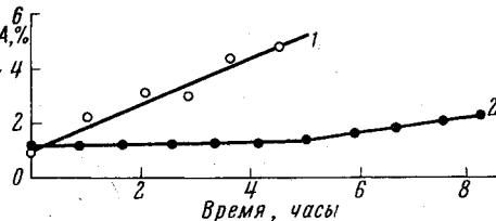
Рис. 3. Зависимость содержания гидроперекисных групп ( $A$ ) в окисляемом дибензиле в присутствии перекиси бензоила (1) и гидроперекиси кумола (2) от продолжительности реакции
