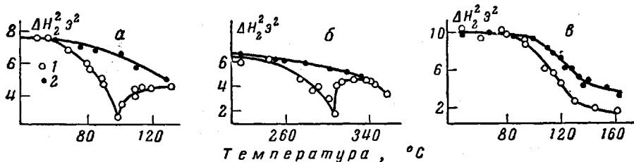
Зависимость  $\Delta H_2^2$  от температуры измерения: *а* — для ПЭТФ, *б* — для АПА, *в* — для изотактического ПС:
