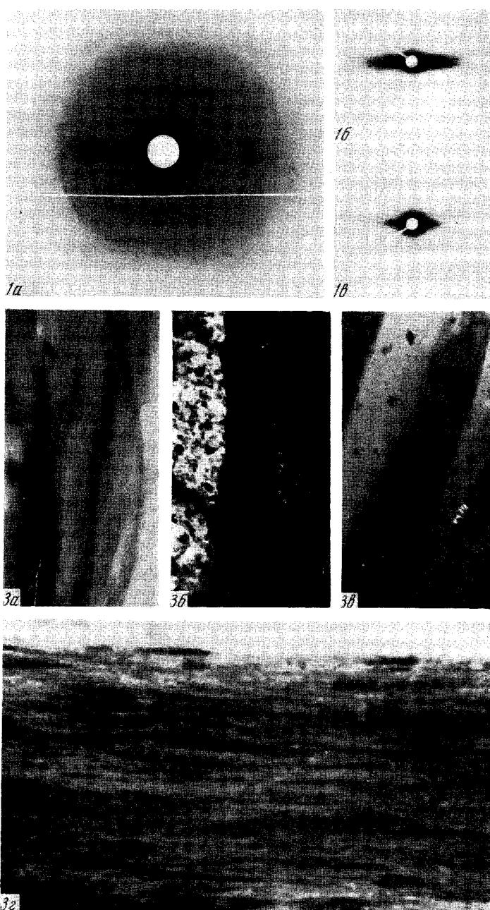
Рис. 1, а — Рентгенограмма в больших углах образца № 4 (таблица); б — малоугловая рентгенограмма образца № 4; в — малоугловая рентгенограмма образца № 1
