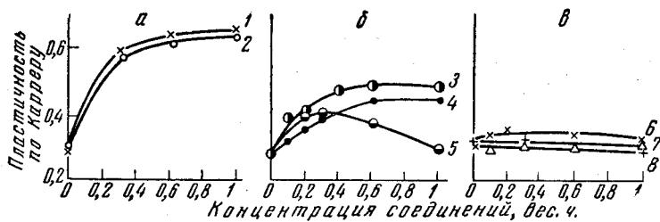
Рис. 1. Ускоряющее действие серусодержащих соединений при пластикации НК на вальцах (температура пластикации 100°):
