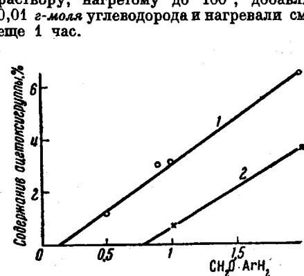
Рис. 3. Влияние соотношения реагентов на состав полимеров, полученных из *n*-ксилола (1) и *m*-ксилола (2)
