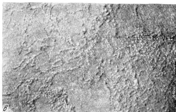
Рис. 3. Поверхность стекла после контакта с полизобутиленом (а),
