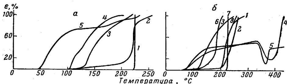
Рис. 1. Термомеханические свойства привитых сополимеров: *а* — из сополимера I и аминоэнантовой кислоты, *б* — из полиметакриловой кислоты и аминоэнантовой кислоты.
