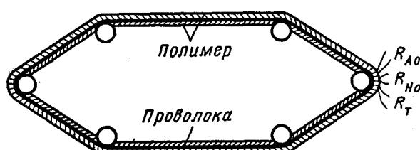
Рис. 1. Схема намотки проволоки на стержни
