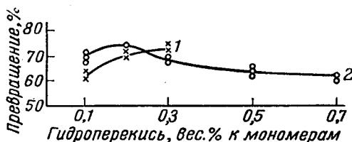
Рис. 4. Влияние концентрации гидроперекиси 1,1-дифенилэтана (1) и *n*-трет. бутилизопропилбензола (2) на выход полимера при эмульсионной сополимеризации бутадиена со стиролом
