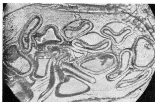
Рис. 7. Поперечный срез нити, полученной в процессе межфазной поликоденсации полигексасебацамида
