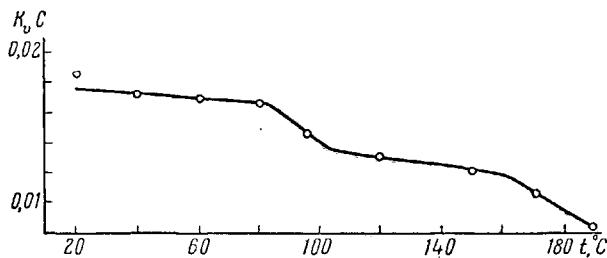
Рис. 5. Изменение аморфной части в пленках, растянутых до 400% при скорости 1 мм/сек
