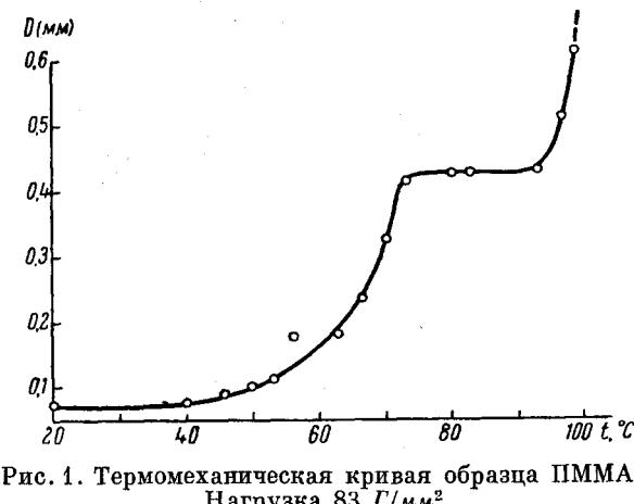
Рис. 1. Термомеханическая кривая образца ПММА.
