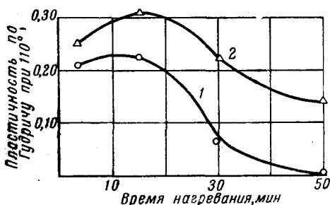
Рис. 7. Кинетика изменения пластичности по Гудричу смесей из СКС-30 АМ с канальной сажей при 110°.
