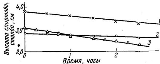
Рис. 2. Производимость целлофановой мембранны для 90 %-ного этанола при температуре термостата 25°
