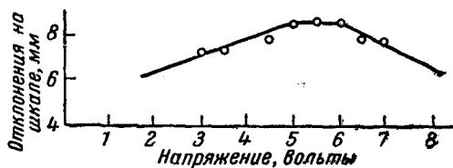
Рис. 2. График зависимости отклонения «зайчика» гальванометра на шкале от напряжения, подаваемого на нагреватель
