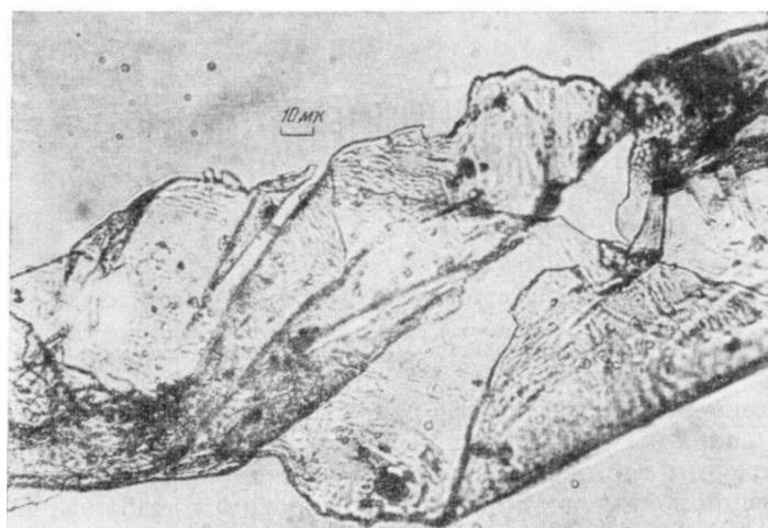
Рис. 4. а — поверхность разрушения на правой половине образца (рис. 2, б) после обработки скребком; фотография в отраженном свете; б — фотография в проходящем свете покровной пленки, снятой с шероховатой поверхности разрушения
