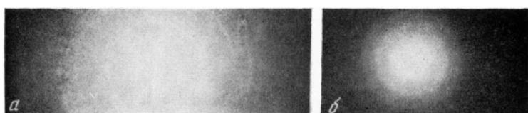
Рис. 3. Электронограммы полипропилена исходного (*а*) и частично деструктированного при  $T=360^\circ$  (*б*)
