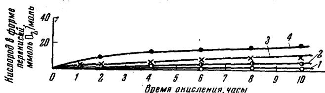
Рис. 6. Накопление стабильных перекисей при окислении растворов натрий-бутадиенового каучука в бензоле при различных температурах
