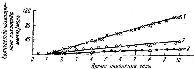
Рис. 8. Кинетика окисления растворов натрий-бутадиенового каучука в ксиоле при различных температурах и накопление перекисей в ходе этого процесса
