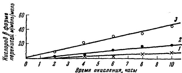
Рис. 7. Накопление стабильных перекисей при окислении растворов натрий-бутадиенового каучука в толуоле при различных температурах
