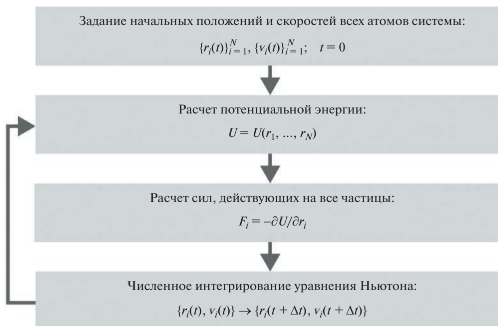
Рис. 1. Общая схема расчета методом классической молекулярной динамики. Цветные рисунки можно посмотреть в электронной версии.
